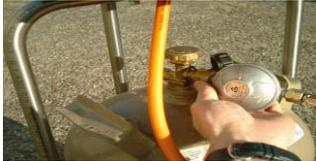
**NACH ANSCHLUSS AN DIE GASFLASCHE LANGSAM DAS VENTIL ÖFFNEN UND DEN ANSCHLUSS MIT LECKSUCHSPRAY ODER SPÜLIWASSER AUF DICHTIGKEIT PRÜFEN.**
