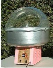
ZUERST UNBEDINGT DIE BEIDEN TRANSPORTSICHERUNGEN DURCH DREHEN DER RÄNDELSCHRAUBEN ( LINKS UND RECHTS NEBEN DEM ZUCKEREINFÜLLSTUTZEN) LÖSEN. DADURCH VERSINKEN DIE GEWINDE-SCHRAUBEN BIS ZUM ANSCHLAG IM GERÄTEINNEREN UND ERMÖGLICHEN DEM MOTOR EINEN RUHIGEN LAUF.
